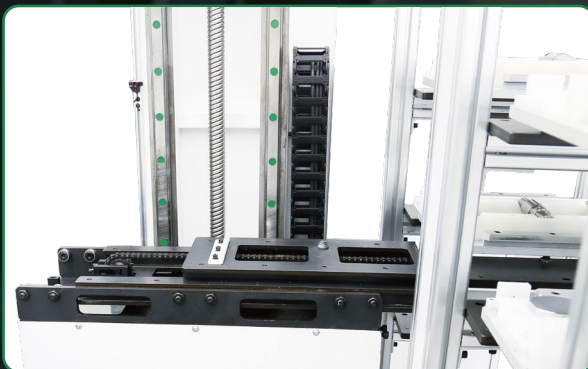
堆垛升降机在上料立库自动拿取工件托盘
