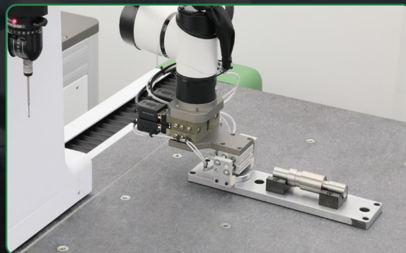
协作机器人自动放置工件配合三坐标自动测量
