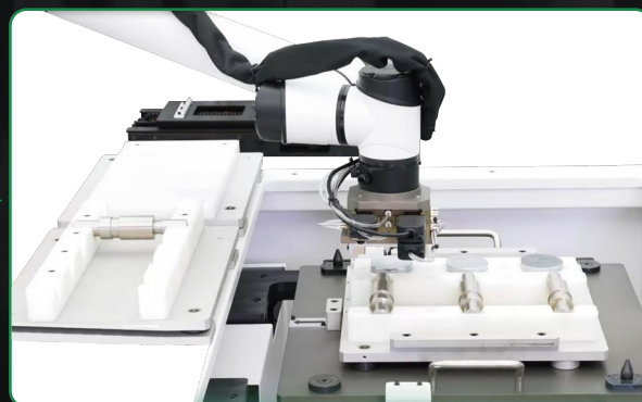
协作机器人饼工件搬运至下料伺服垛机OK或NG相应位置
