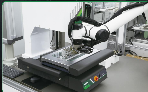
协作机器人自动放置工件配合影像仪自动测量
