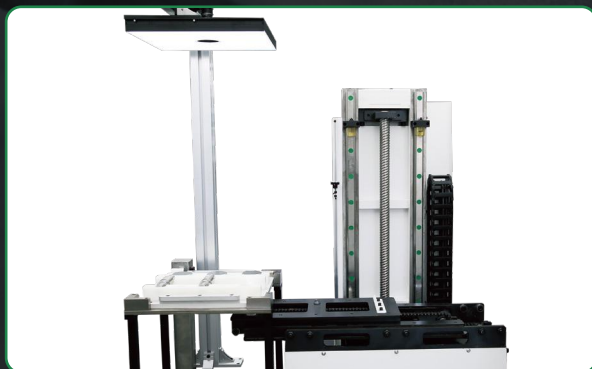
堆垛升降机自动运送工件托盘至视觉定位平台 视觉定位平台自动对工件摆放位置进行确认
